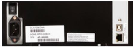
Mit eingebauten LAN & USB Schnittstellen bietet der CL-E720DT verschiedene Möglichkeiten für den Anschluß an einen PC.
