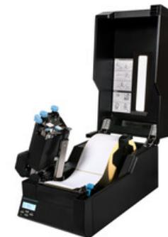
Durch den Frontzugriff auf alle Standard-Funktionen ist der Drucker für das leichte Laden von Medien und die einfache Wartung ausgelegt.
