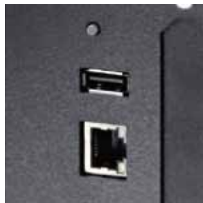
USB Host für höhere Speicherkapazität und Standalone-Modus
