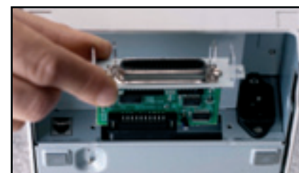
Internes Netzteil & „Plug-in“-Schnittstellen
